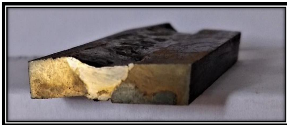
FIGURA 3 – Análise macrográfica (soldagem com eletrodo ENi-CI [92.18] a 800 °C)
