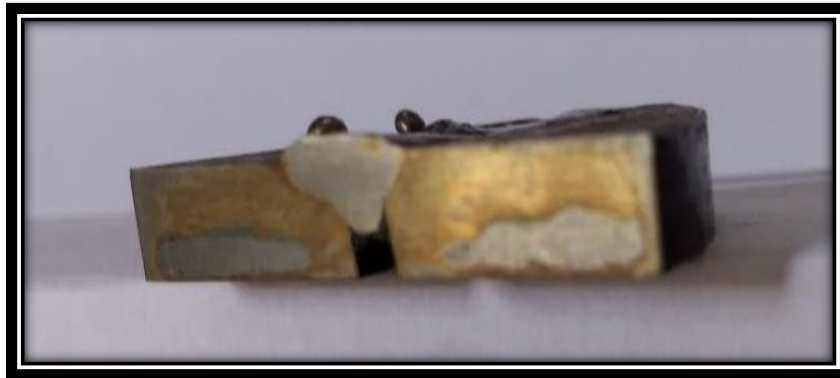
Figura 5 - Análise macrográfica (soldagem com eletrodo ENi-CI [92.18] na técnica a frio)
