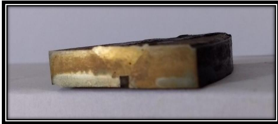
Figura 6 - Análise macrográfica (soldagem com eletrodo E7018 na técnica a frio)
