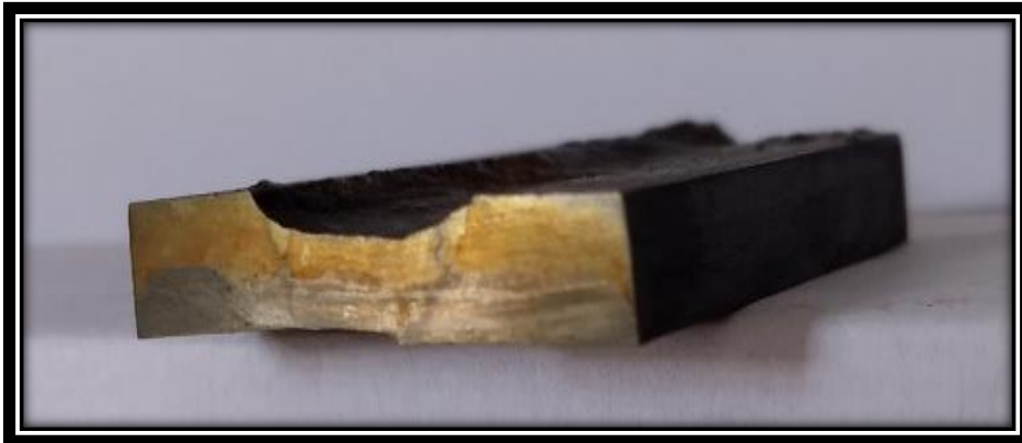
Figura 4 - Análise macrográfica (soldagem com eletrodo E7018 a 800 °C)
